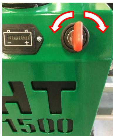
Abbildung 5.1 – Schlüsselschalter
